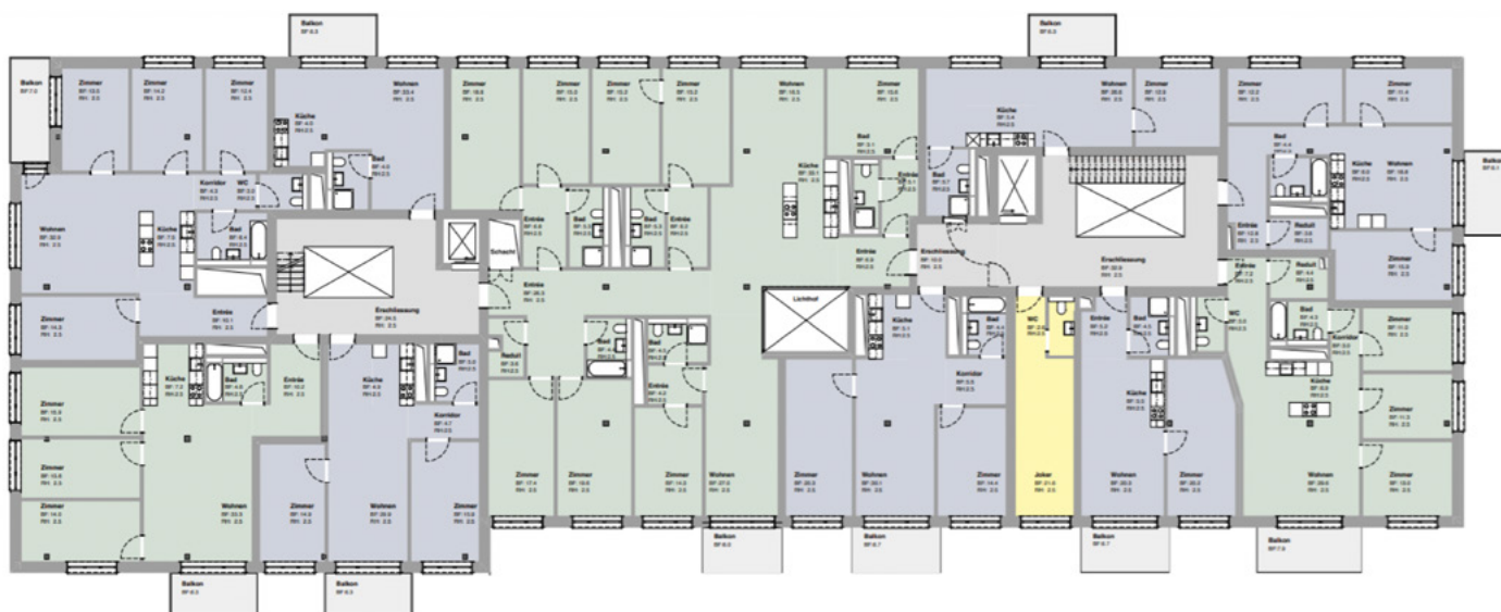
Beispiel eines Geschoss-Grundrisses der Güterstrasse 8 (5. Obergeschoss) mit einem Wohnungsmix von 1-Personen-Haushalt bis zu 8-10-Personen-Haushalt (Quelle: BHSF Architekten, Zürich).
